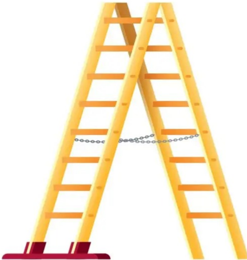
Figur 5 - Wienerstige med forsvarlig sikring og stigefod
