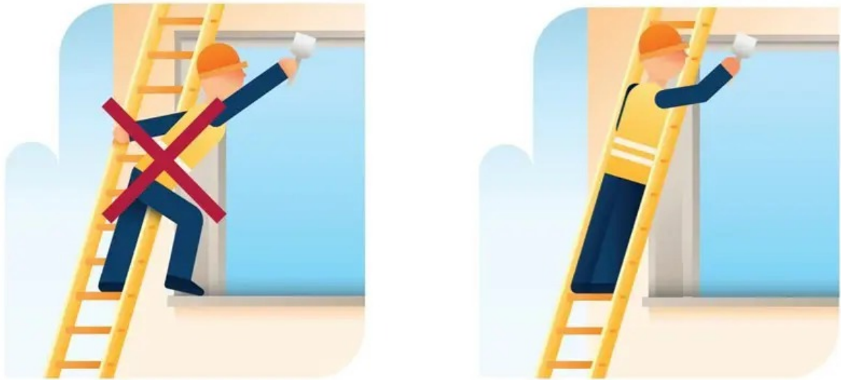
Figur 1 - Arbejde fra transportabel stige skal foregå inden for én armlængde ud fra stigevangen.
